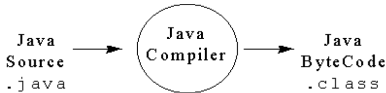
Abbildung 2: Übersetzung von Java-Quellcode in Java-Bytecode
